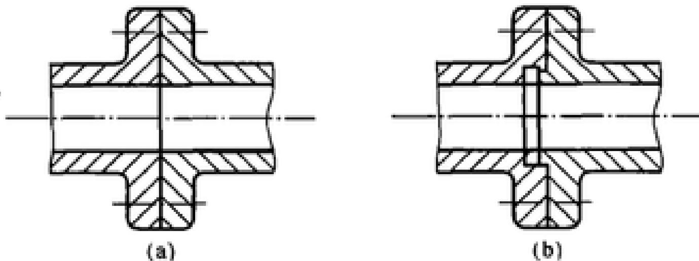
图 12-16 法兰盘的定位基准
