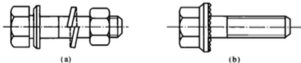
图 12-11 螺钉的集成结构
