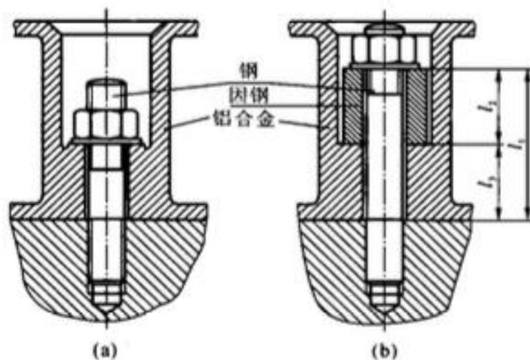
图 12-29 钢制螺栓与铝制法兰盘的连接
