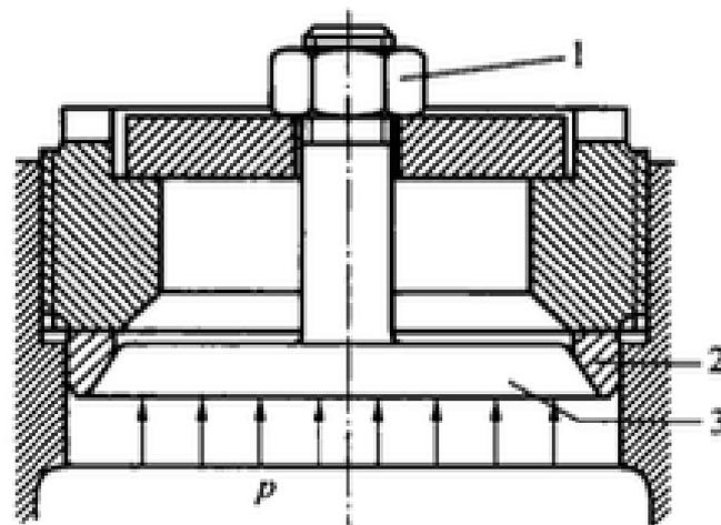
图 12-26 压力容器的密封装置
