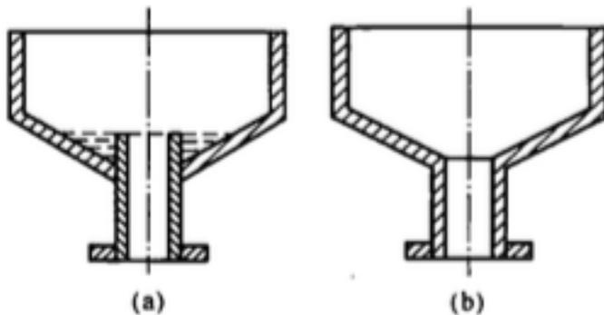
图 12-30 容器的防腐蚀结构
