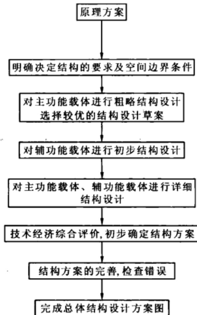
图 12-1 结构设计的工作流程
