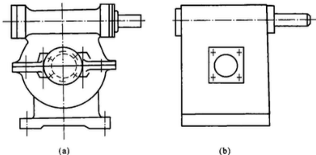
图 12-13 蜗杆减速器的箱体造型
