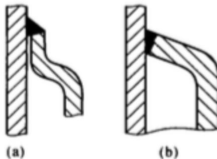
图 12-31 焊接时避免狭缝
