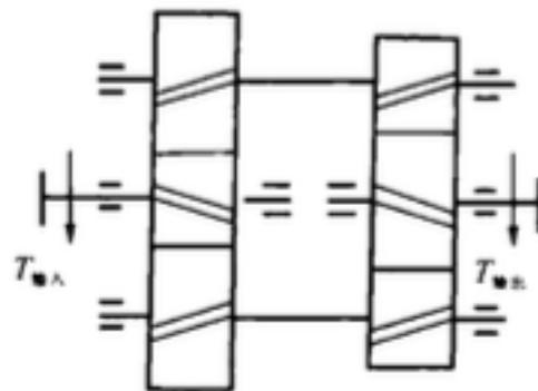
图 12-9 分流式齿轮传动
