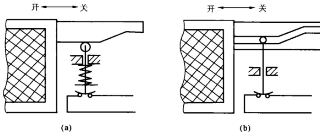
图 12-5 机床保护罩的结构安全性
