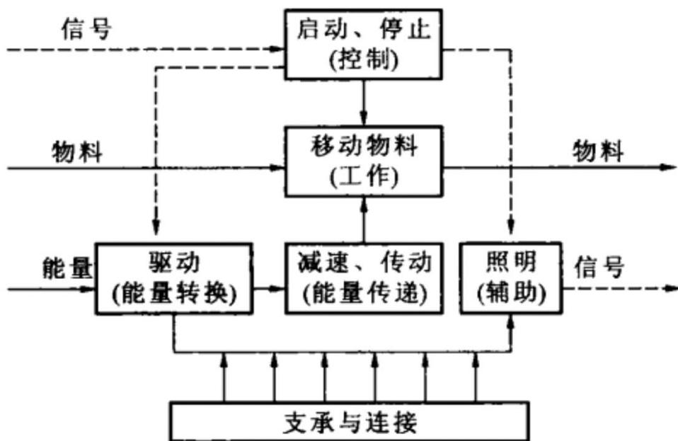
图 1-2 带式输送机功能结构图
