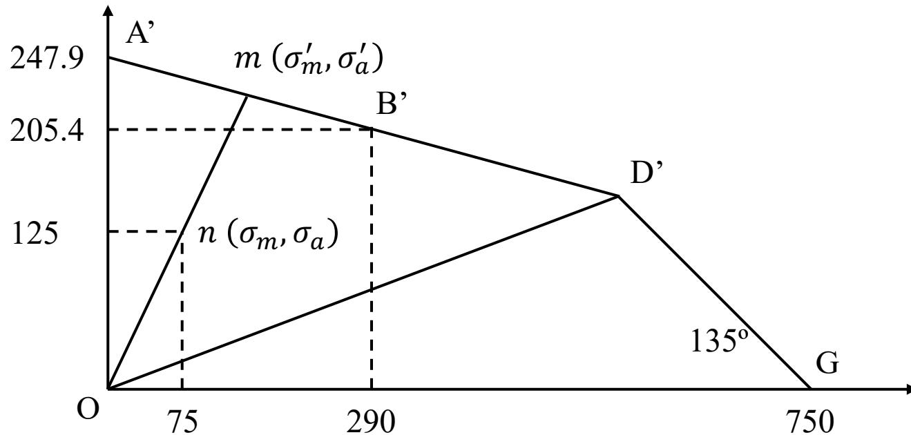
此外，还可通过计算得知工作应力点位置。已知 $\sigma_0 = 580\text{ MPa}$ ,  $\sigma_{-1} = 350\text{ MPa}$ , 则等效系数
